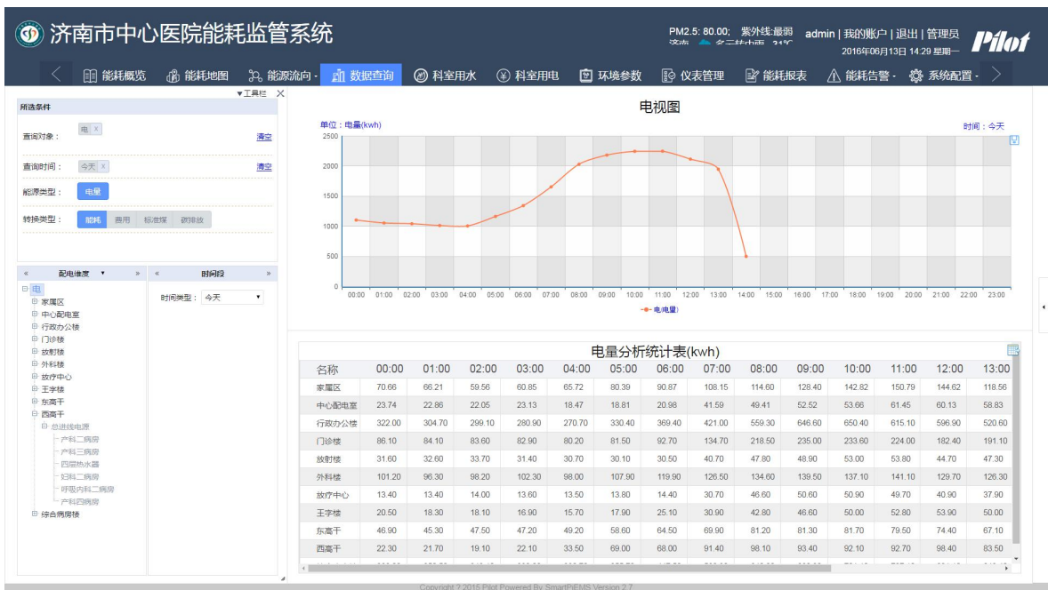
医院建筑能耗监管系统界面-数据查询
